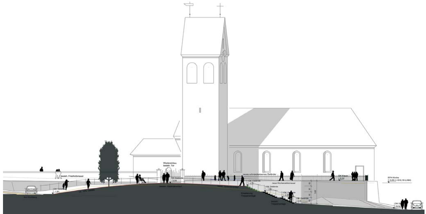
1 Ansicht Kirche 2 Statisch Instandgesetzte Stützmauer
